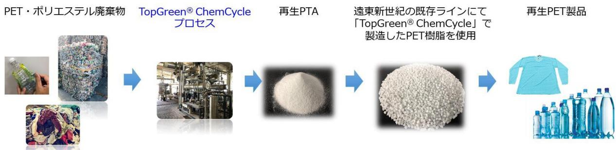
「TopGreen® ChemCycle」以外の一般的なケミカルリサイクルは、使用済み PET ボトルを PET 樹脂製造時の中間原料に戻し、精製したあと、PET に再重合するという手法ですが、遠東新世紀が新たに開発した「TopGreen® ChemCycle」では、PET 樹脂の原料である PTA（高純度テレフタル酸）にまで変換します。PTA にまで変換することで、よりバージン PET 樹脂の品質に近い、再生 PET 原料の製造を実現しました。本プロジェクトにおいて使用予定の PET 樹脂は、「TopGreen® ChemCycle」によって製造された rPTA を原料の一部として使用しており、従来から使用している PET ボトル用原料と同等の品質および安全性を有しています。
